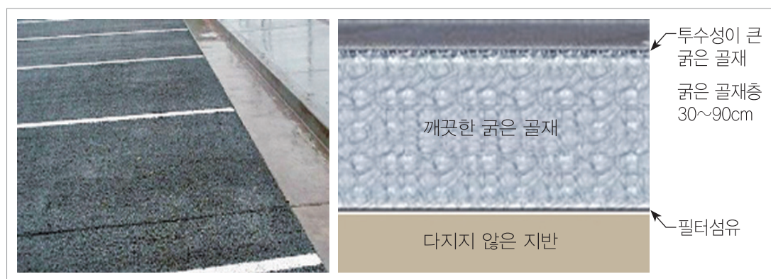
〈그림 24〉 유공포장 설치 예 및 단면도
